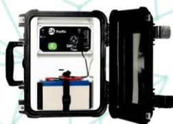
Le **TrafficRadar** permet d'analyser et de compter les deux roues, véhicules légers et véhicules lourds sur 2 voies uni ou bidirectionnelles.
