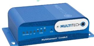
La **Gateway Conduit** est configurable, gérable et évolutive pour les diverses solutions IoT. Connectée en LoRa, elle bénéficie d'une basse consommation, d'une longue distance et est idéale pour les capteurs émettant périodiquement.
