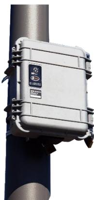
Ce compteur **CityRadar** permet le comptage directionnel des vélos et des piétons. Il peut également être utilisé pour un comptage non intrusif des véhicules et des deux roues sur une ou deux voies. De ce fait, il est possible de connaître la vitesse, la classification de longueur, l'inter distance et de faire des enregistrements individuels ou agrégés.
