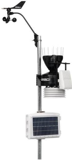
La **station météorologique LWWS00 de Enginko** alimenté avec un panneau solaire et une batterie (de 12 AH, 6V) peut mesurer la température extérieure et l'humidité, la pression barométrique, les précipitations, les points de rosée, le rayonnement solaire, les particules fines. Elle peut également capter la vitesse et la direction du vent.
